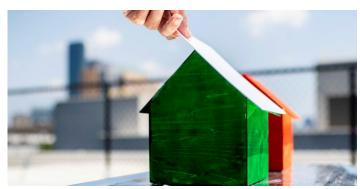
Um novo material criado em laboratório permite baixar a temperatura da divisão de uma casa em até dez graus. Não requer eletricidade e é 100% reciclável.
